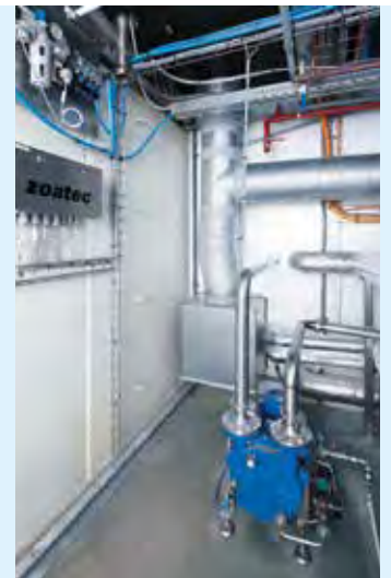
Vakuumpumpe zur Erzeugung des Unterdrucks im Prozessbehälter
