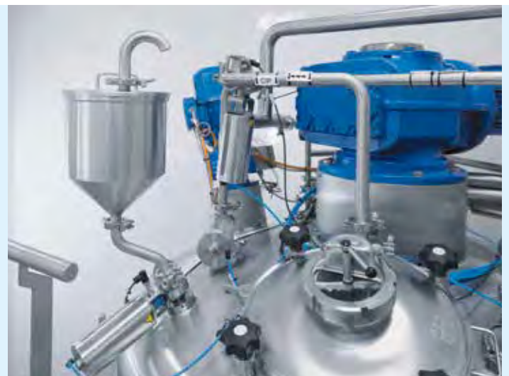
Vorlagebehälter für flüssige Rohstoffe
