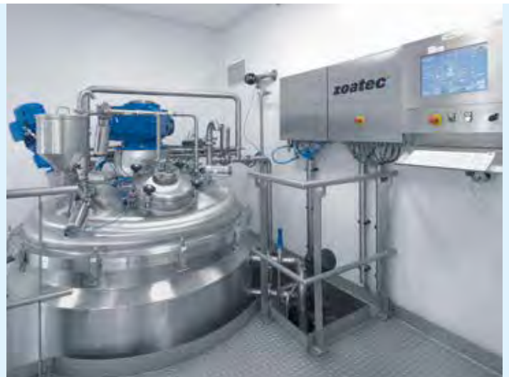
Prozessbehälter mit zoamatic-Steuerung
