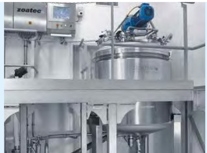
Schmelzbehälter zum Aufschmelzen und Erwärmen von Fetten und Ölen
