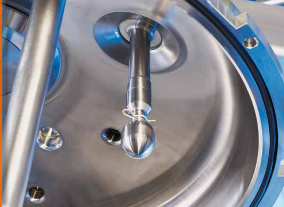
Sprühdüsen für eine gründliche CIP-Reinigung
